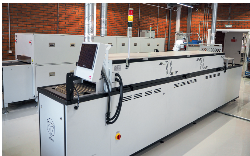
Печи для сушки (на переднем плане) и вжигания (на заднем плане) серебросодержащей пасты
