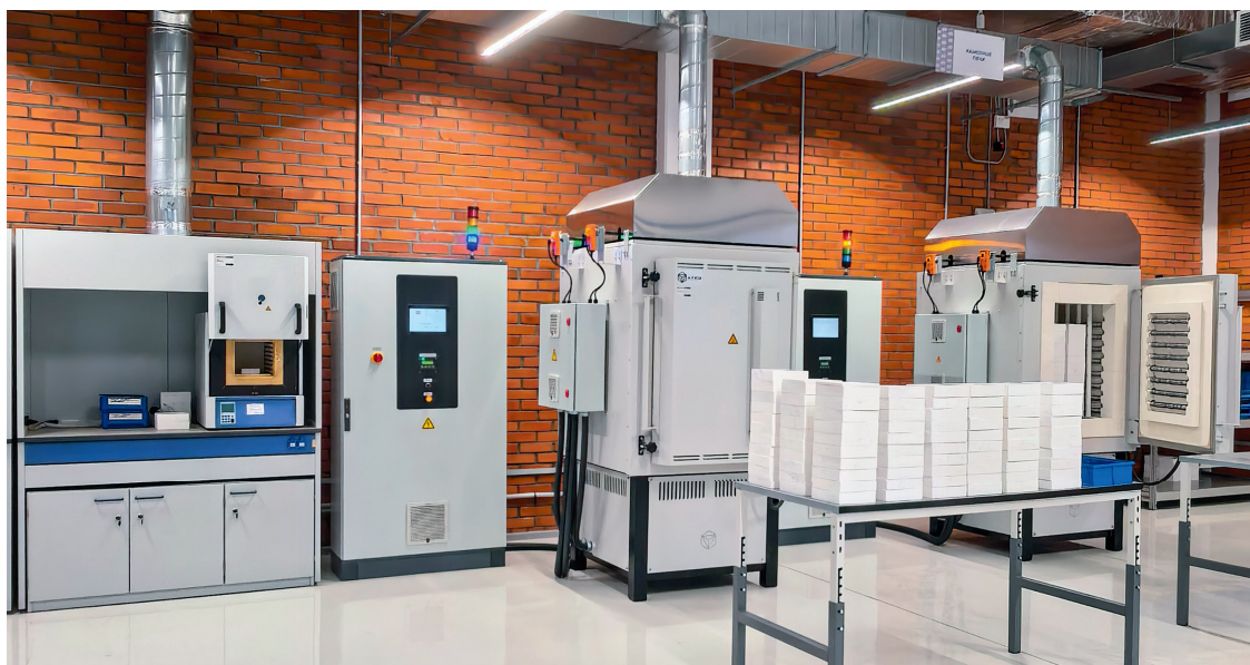
Участок высокотемпературного обжига. Слева – муфельная печь; справа – две камерные печи с опцией утильного обжига (удаления связующего)
