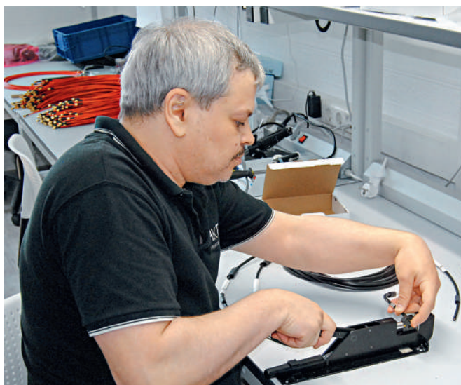
Выполнение монтажа соединителя методом обжима
