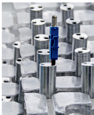
Оптический наконечник в бронзовой втулке и алюминиевом держателе
