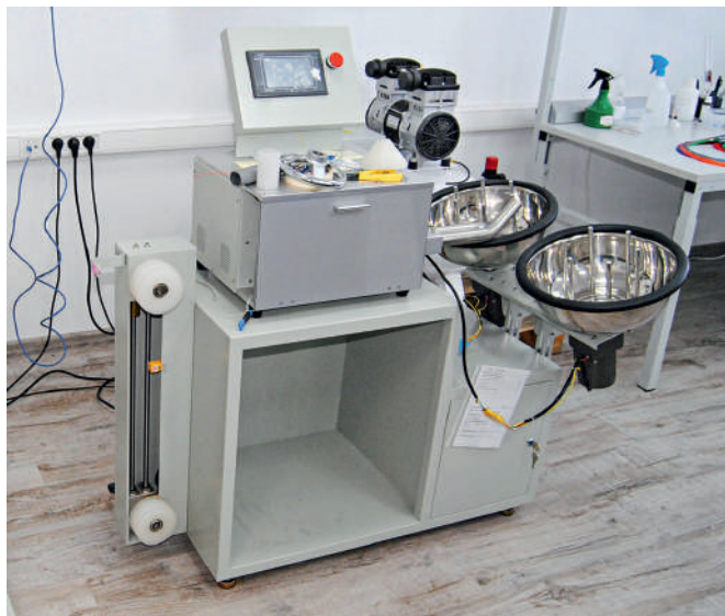
Установка нарезки оптического кабеля. В правой ее части видны два лотка для бухт нарезанных заготовок
