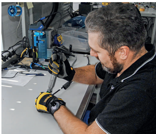
Монтаж соединителя методом резьбовой сборки
