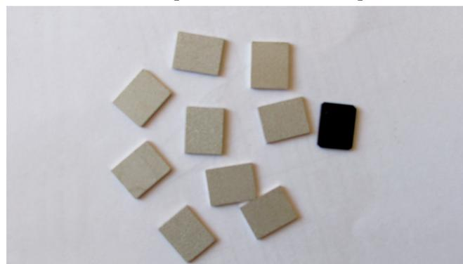
**Рис.6.** Металлизированные теплоотводы из АКК "Скелетон"
