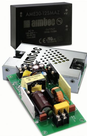
Преобразователи AMES(C)15/30/40-MAZ – это компактные AC-DC преобразователи в металлических корпусах мощностью 15, 30 и 40 Вт с гальванической развязкой 4000 В AC и с одним или двумя симметричными выходами. Предназначены для установки на шасси или, с помощью замка DRB01, на DIN-рейку TS35/7.5.
