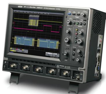
В состав осциллографов смешанных сигналов **WaveSurfer MSO MXs-B** входят штатный логический пробник MS-250 для подключения 18 цифровых каналов. Максимальная тактовая частота входного сигнала, достигающая 250 МГц, обеспечивается записью до 10 мс цифровых данных по всем 18 каналам. Осциллографы
