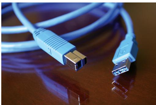
**Рис.8.** Соединитель USB 3.0
