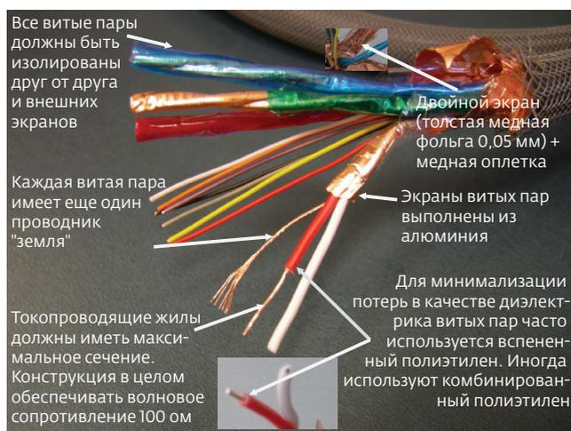
**Рис.2.** Конструкция высокоскоростного кабеля HDMI без Ethernet
