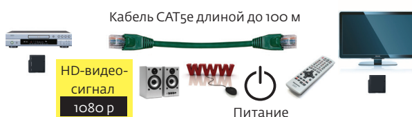
Рис.1. Передача пяти различных данных (5Play) по одному сетевому кабелю
