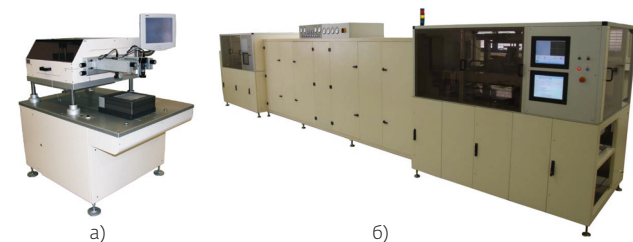
Рис.3. Принтеры трафаретной печати производства KEKO Equipment (Словения): а) P-200 – для опытно-конструкторского и мелкосерийного производства; б) RTP-15P – для крупносерийного производства
