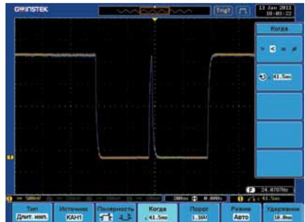
Рис.4. Настройка синхронизации для обнаружения аномалий в сигнале
