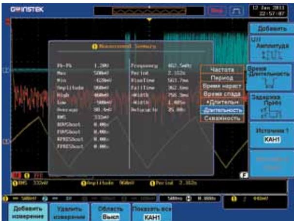
Рис.6. Автоматические измерения в сигнале
