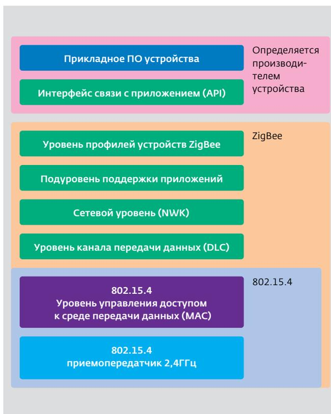
Рис.1. Структура протокола ZigBee
