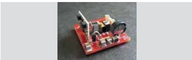
Рис.4. ЭМ-преобразователь энергии колебаний, полностью выполненный по МЭМС-технологии
