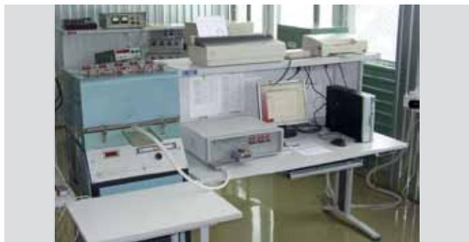
Рис.3. Установка измерения статических характеристик ЦАП "УИСП-70"
