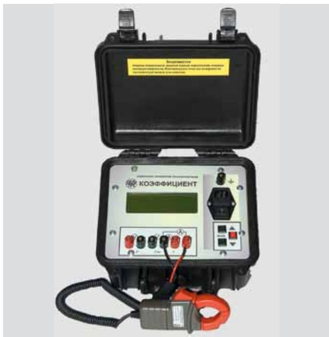
Рис.3. Измеритель параметров трансформаторов "Коэффициент"
