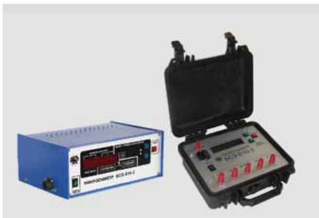
Рис.1. Микроомметры БСЗ-010
