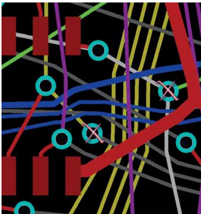
Рис.9. Избыточные переходы на многослойной печатной плате
