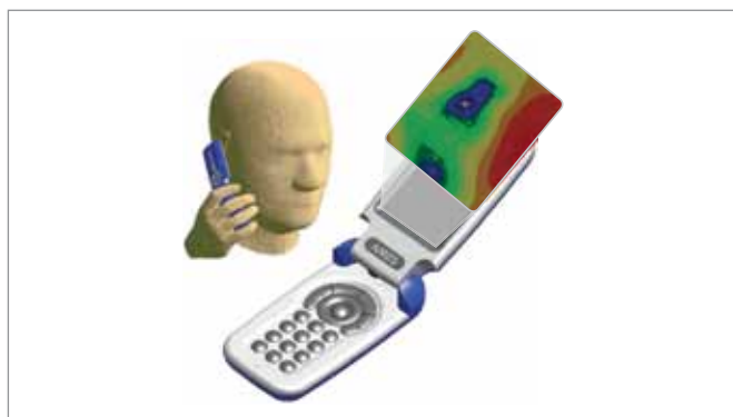
Рис.9. Оценка излучения антенны мобильного телефона – пример применения метода FDTD
