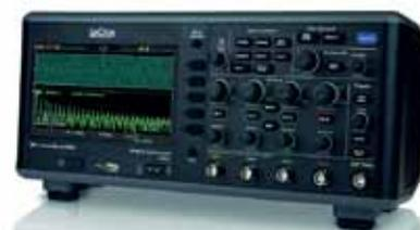
Осциллографы оснащены интерфейсами LAN (все 4-канальные модели) и USB2.0 на задней панели осциллографа для дистанционного управления и программирования с внешнего ПК (в том числе по протоколу LXI), а также USB-портами для флеш-устройств на передней и задней панелях осциллографа для сохранения результатов.
