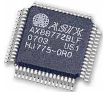
Компания ASIX Electronics предлагает интегральные USB-to-LAN (Ethernet-USB) контроллеры AX88772B. Эти контроллеры отличает простота использования, доступность документации, программных драйверов и отладочных средств от производителя.
