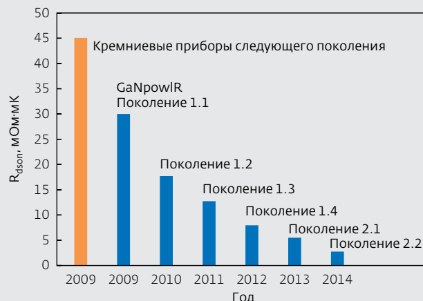
Рис.7. Прогнозируемое изменение показателя R_{\text{ds(on)}}Q_g для 30-В GaN HFET
