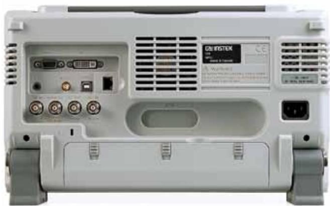
Рис.13. Разъемы на задней панели GSP-7930
