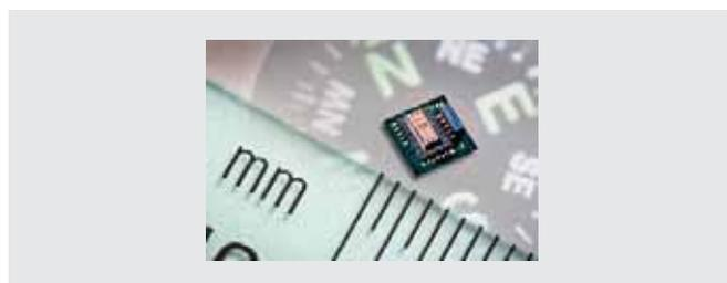
Рис.6. Трехосевой магнитометр MMC3316xMT
