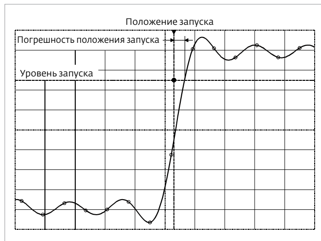
Рис.3. Пример несоответствия между отображаемым сигналом и фактической точкой запуска
