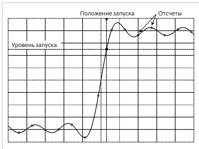
Рис.2. Пример измеряемого сигнала с отсчетами АЦП и точкой запуска
