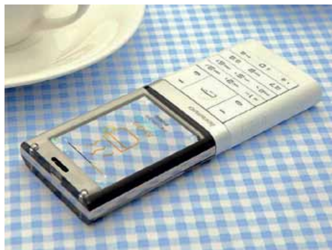
Рис.3. Телефон с прозрачным OLED-дисплеем Futaba
