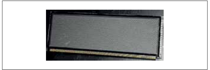
Рис.10. Плазменная панель компании Integrated Sensors, выполняющая функции счетчика Гейгера
