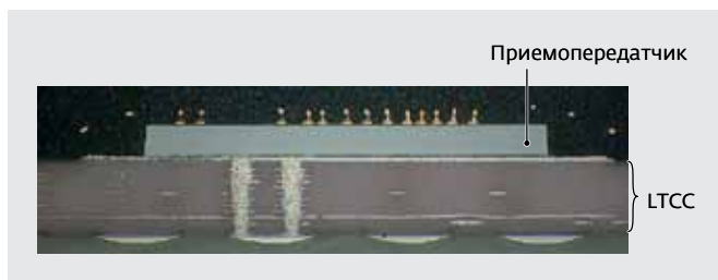
Рис.7. Приемопередатчик на многослойной LTCC-подложке со встроенными компонентами
