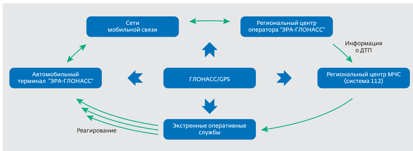
Рис.4. Схема работы системы "ЭРА-ГЛОСС"
