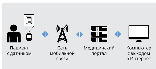
Рис.2. Схема системы мониторинга состояния здоровья Assisted Living
