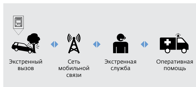
Рис.3. Схема системы e-Call
