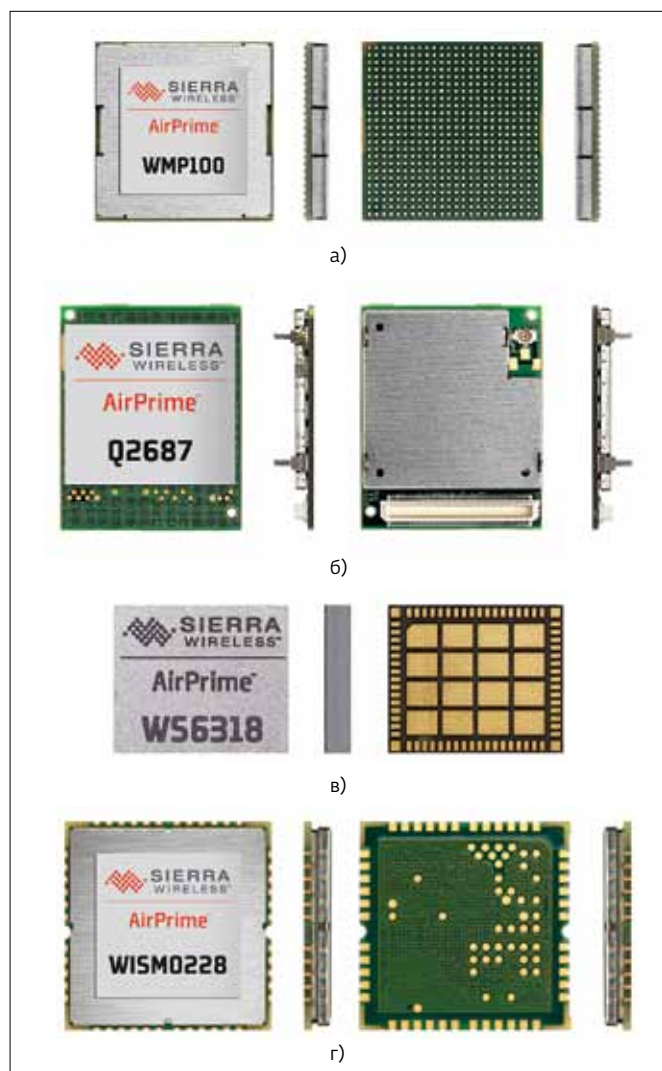
Рис.5. GSM-модули компании Sierra Wireless: а – WMP100; б – Q2687; в – WS6318, г – WISMO228
