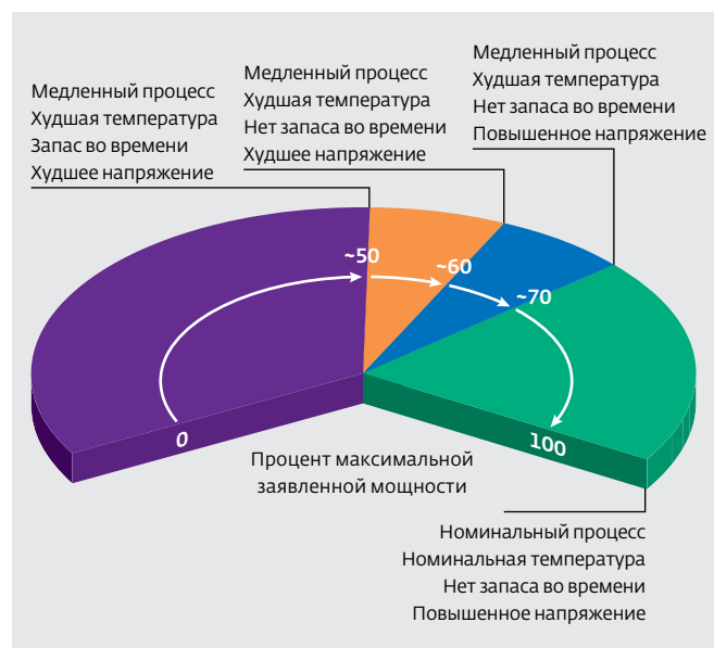
Рис.2. Ухудшение реальных характеристик IP-блока по сравнению с заявленными
