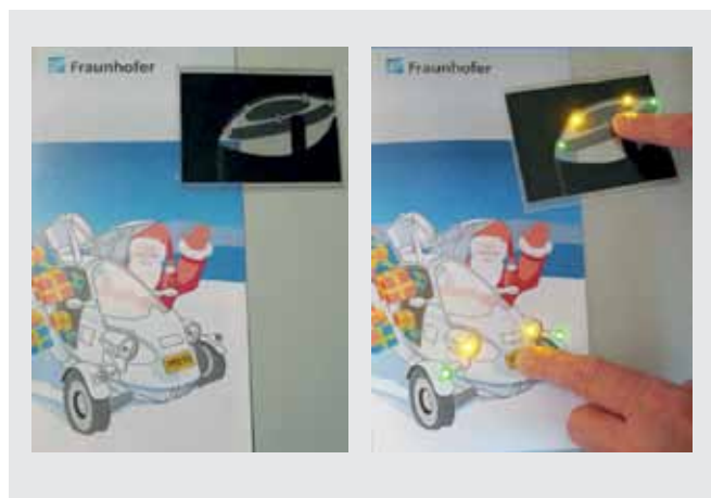
Рис.10. Интерактивная открытка, в которой гибкая печатная батарейка используется для питания светодиодов [5]
