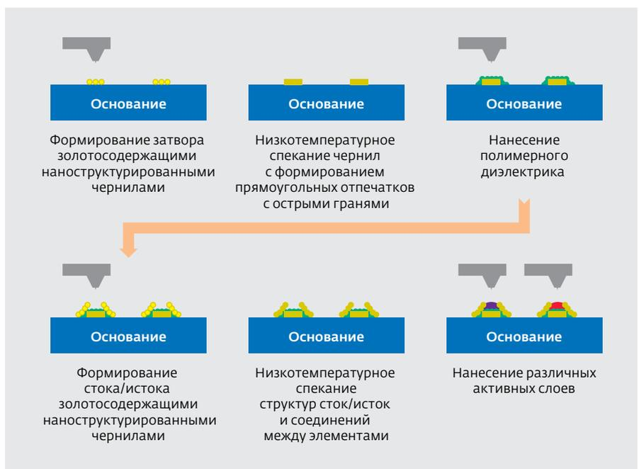
**Рис.13.** Технологический процесс формирования полупроводниковой структуры методом струйной печати
