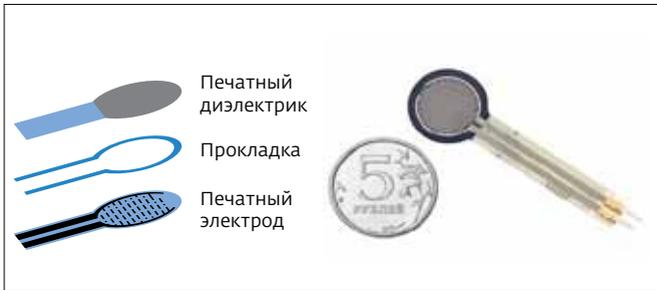
**Рис.11.** Контактный сенсор (источник ф. Network of Excellence Robotic & Mechatronics)
