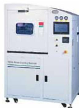
Компания "ЛионТех" представляет полностью автоматическую систему отмывки печатных плат KED600. Она включает все необходимые опции для отмывки моющим раствором, ополаскивания дистиллированной водой и сушки горячим воздухом. Основные особенности системы:
