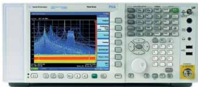
Рис.1. Анализатор спектра реального времени PXA N9030A
