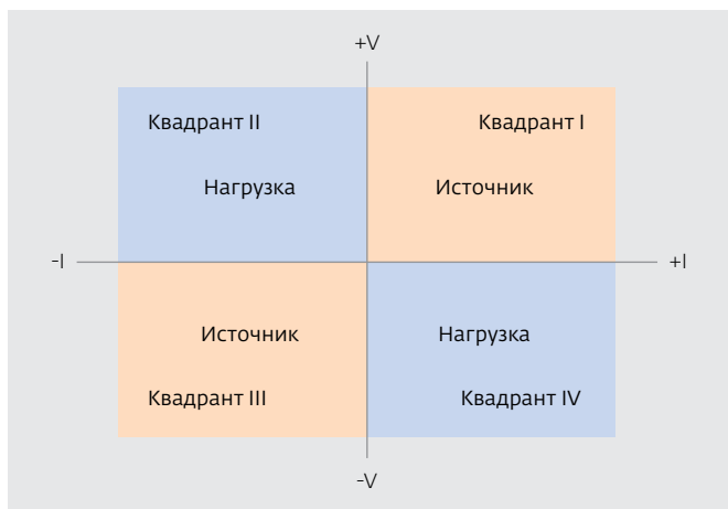
Рис.2. Вольт-амперная характеристика источников питания АК ИП-1106/1106А
