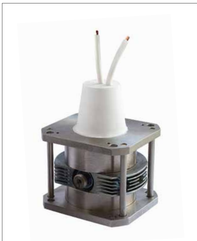
Рис.1. Макет магнетрона 2-мм диапазона длин волн
