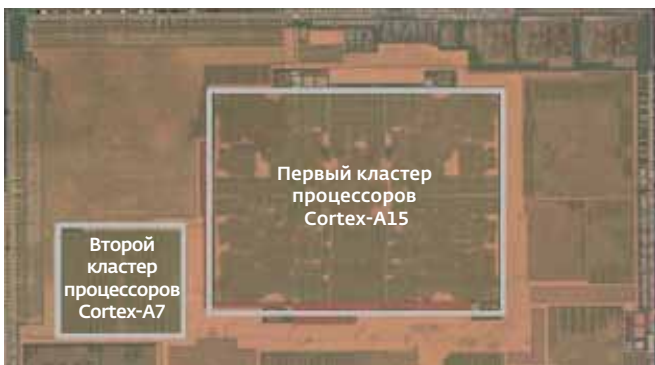
Рис.8. Структура процессора Exynos Octa с двумя кластерами четырехканальных процессоров
