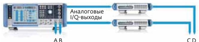
Рис.8. Схема MIMO 4x4, реализованная с помощью генераторов сигналов SMW200A и SGS100A. А, В, С, D – ВЧ-каналы
