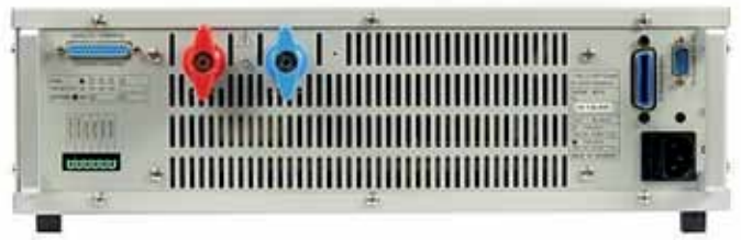
Рис.6. Задняя панель АК ИП-1107А-40-100. Цепи ОС (зеленая колодка) – слева, полярные клеммы ("под винт") –верху
