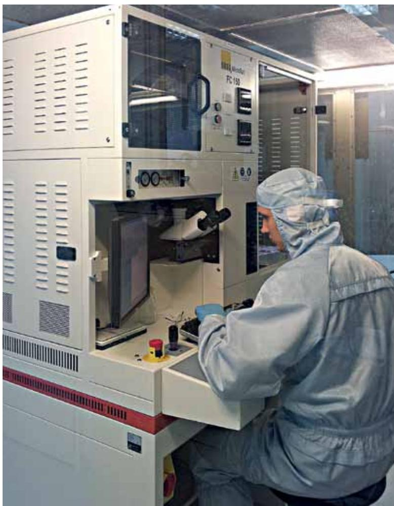
Прецизионный установщик кристаллов Suss Micro Tec FC-150
