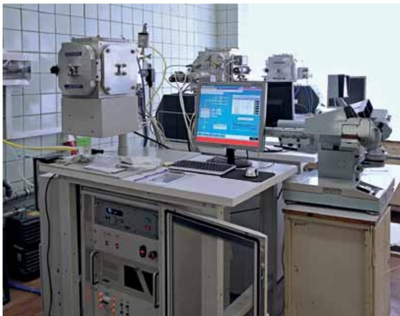
Малогабаритная вакуумная установка реактивно-ионного травления "МВУ ТМ РИТ"
