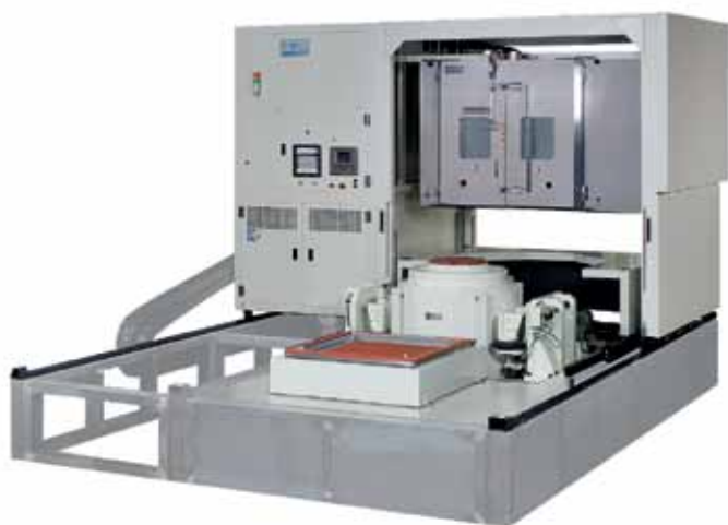
Рис.3. Комбинированная установка компании EMIC. Вибростенд: усилие 60 кН, охлаждение воздушное, оборудован горизонтальным столом со сменяемыми плитами. Камера: термоудар, объем 1000 л, температура от -70 до 200 °С. Усилитель вибростенда, холодильный и электрический отсеки камеры выполнены в общем корпусе
