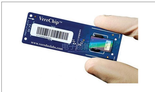
Рис.3. Лаборатория на кристалле VereFlu
