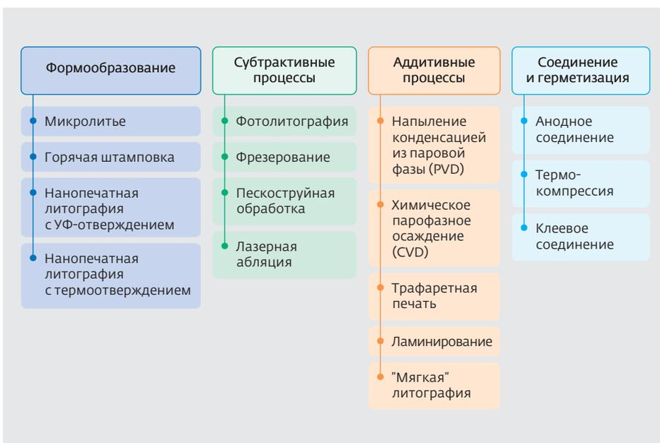
**Рис.10.** Классификация технологий, применяемых для изготовления микрофлюидных модулей. Источник: Yole Développement. Microfluidic Substrate Market & Processing Trends (2012)
