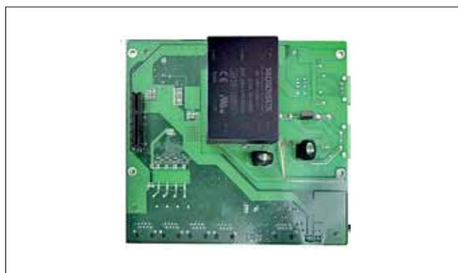
**Рис.5.** Повреждение платы в результате перенапряжения из-за ошибки в схеме
