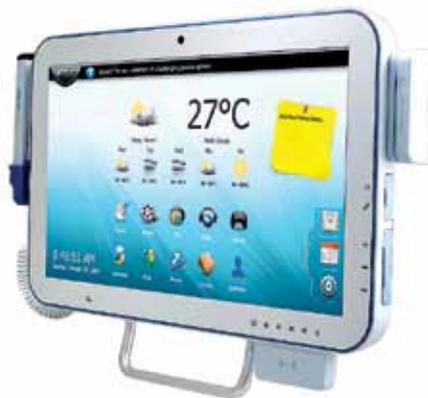
Компания Avalue начала серийные поставки специализированного медицинского панельного компьютера AID-173S. Краткие технические характеристики AID-173S: дисплей 17,3"; процессор Intel Core-i/Celeron/Atom в зависимости от комплектации; LED-подсветка монитора; жесткий диск 2,5" SATA 320 Гбайт; объем оперативной памяти 2 Гбайт.
