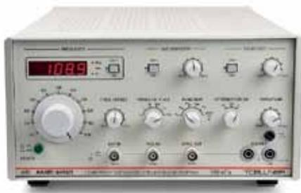
частотомер, работающий в диапазоне 1 Гц – 30 МГц (АК ИП-3414, АК ИП-3416) и 10 Гц – 50 МГц (АК ИП-3415). Встроенные стандартные формы сигнала представлены четырьмя типами: синусоидальный, прямоугольный, треугольный/пилообразный, импульс. Генераторы поддерживают функции изменения симметрии сигнала и установки постоянного напряжения смещения выходного сигнала. Погрешность источника опорной частоты составляет  $\pm 2 \times 10^{-6}$ .
