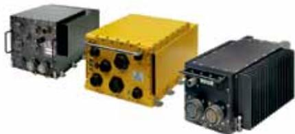
ходимости может быть легко заменен. Входящий в комплект поставки блок питания имеет выходную мощность 150 Вт, входное напряжение 28 В, три выходных напряжения (5; 3,3 и ±12 В) и высокий КПД (85%). Стандартное время автономной работы 4 мс можно увеличить до 50 мс за счет использования блока конденсаторов.
