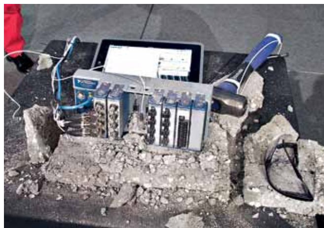
Рис.6. Шасси cDAQ-9188XT для жестких условий эксплуатации. Работающее устройство заключили в цементный блок и разбили молотком – а оно продолжает работать
