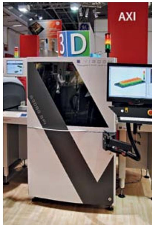
трафарета, и скорректирует совмещение трафарета с платой. В случае обнаружения дефекта на стадии инспекции платы после пайки, путем анализа данных, полученных с SPI, можно определить, на какой стадии возник дефект – при нанесении паяльной пасты, при установке компонента или в ходе оплавления.
