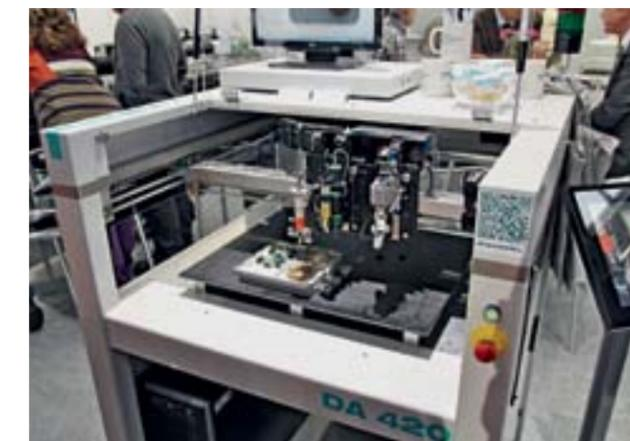
установлены насадки для различных материалов – паяльной пасты, клея, компаундов, а также масла и прочих жидкостей. Система приводов головок и система технического зрения автомата обеспечивают точность дозирования 30 мкм.
