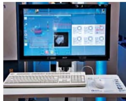
пайкой, после нее платы направляются на пайку, а потом возвращаются в автомат АОИ, но уже в нижний модуль, который проверяет качество пайки. Этот автомат можно использовать и для инспекции качества поверхностного монтажа.
