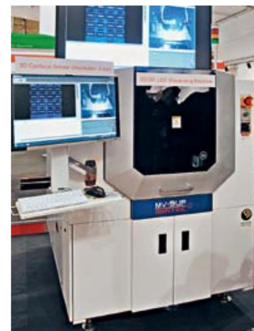
Система АОИ MV-7 (слева), автомат инспекции заливки гель-люминофорной смесью MV-9UP (справа)
