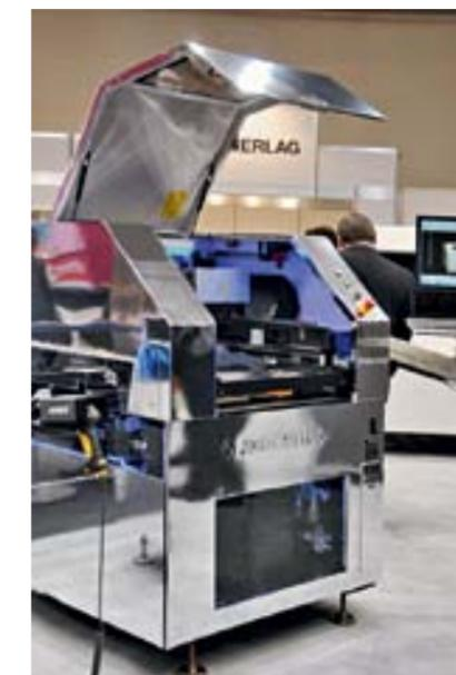
традиционной системы; для крупносерийного производства это внушительная сумма денег! Также принтеры MPM Momentum Compact имеют очень важную особенность – возможность установки в принтер головки дозирования Camalot. Это позволяет дополнительно наносить на плату паяльную пасту или клей – независимо или в цикле трафаретной печати.
