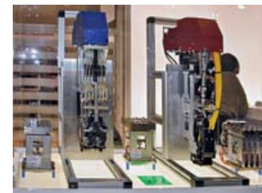
Модульные установщики компонентов YSM40 (слева), их головки на отдельном стенде (справа)
