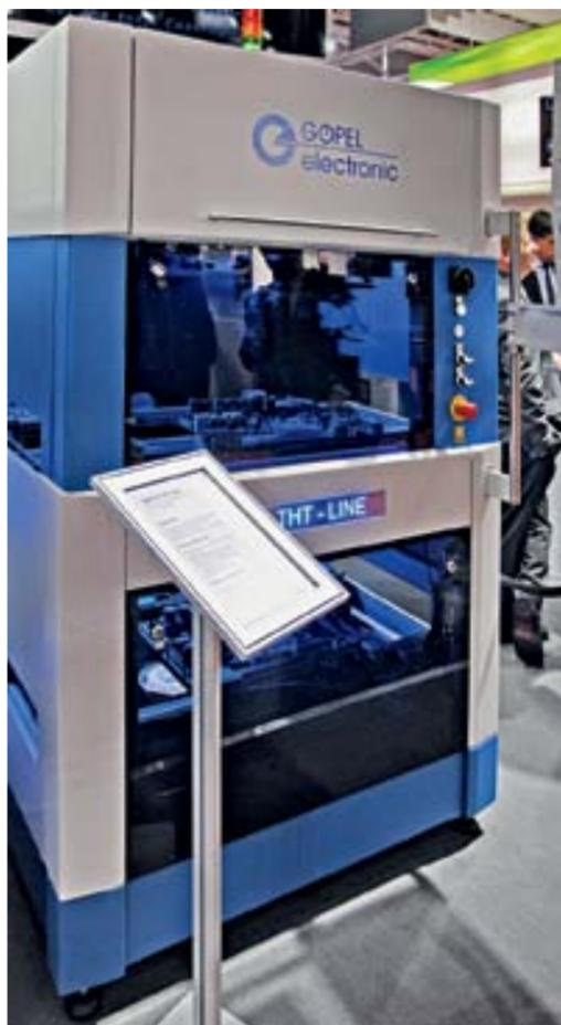
волновой пайки. Особенность автомата – его структура и возможность одновременной проверки обеих сторон печатного узла. Установка состоит из двух независимых модулей инспекции, расположенных один над другим. Один из примеров применения такой системы – инспекция правильности установки компонентов перед
