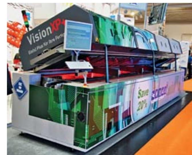
циркуляции и фильтрации. Компания Rehm уделяет очень серьезное внимание экономии расходных материалов, и это снижает стоимость владения оборудованием. Наличие вакуумной камеры с давлением 2 мбар для удаления пустот из паяльного материала гарантирует высокое качество оплавления.
