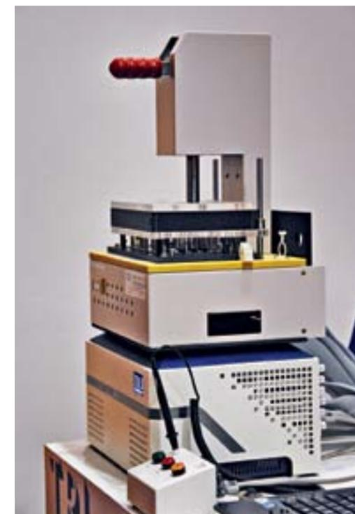
Компактный прибор внутрисхемного тестирования TR5001T Tiny
