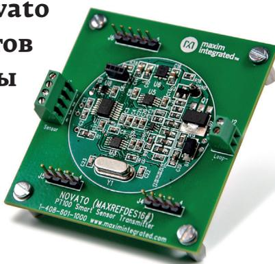
живает входные сигналы 2-, 3- или 4-проводного резистивного датчика температуры (RTD) и работает со всеми типами датчиков RTD: от PT100 до PT1000, благодаря чему идеально подходит для широкого круга промышленных приложений.
