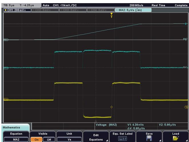
**Рис.4.** Измерение площади знакопеременного импульса с использованием расчетных осциллограмм
