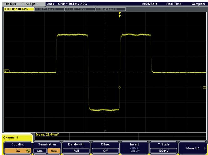
**Рис.3.** Измерение площади знакопеременных импульсов
