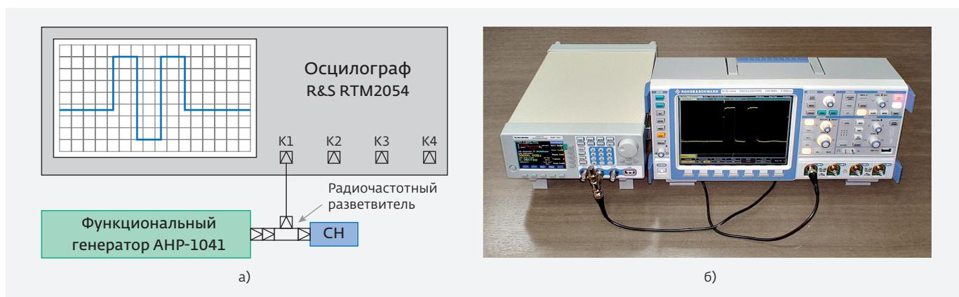
Рис.1. Измерительная установка: а) схема; б) внешний вид
