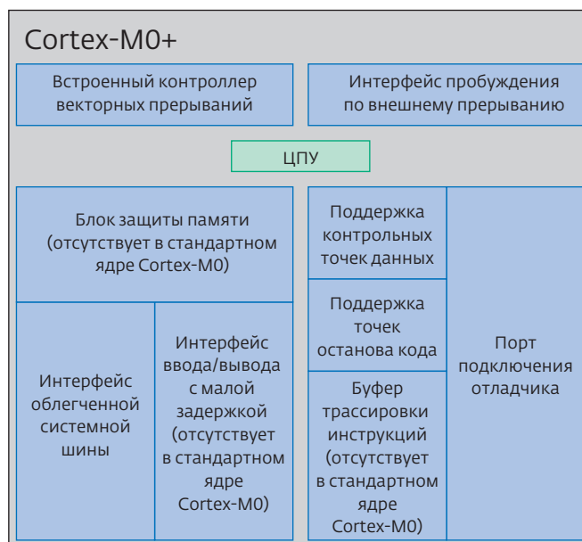
Рис.1. Блок-схема ядра ARM Cortex-M0+
