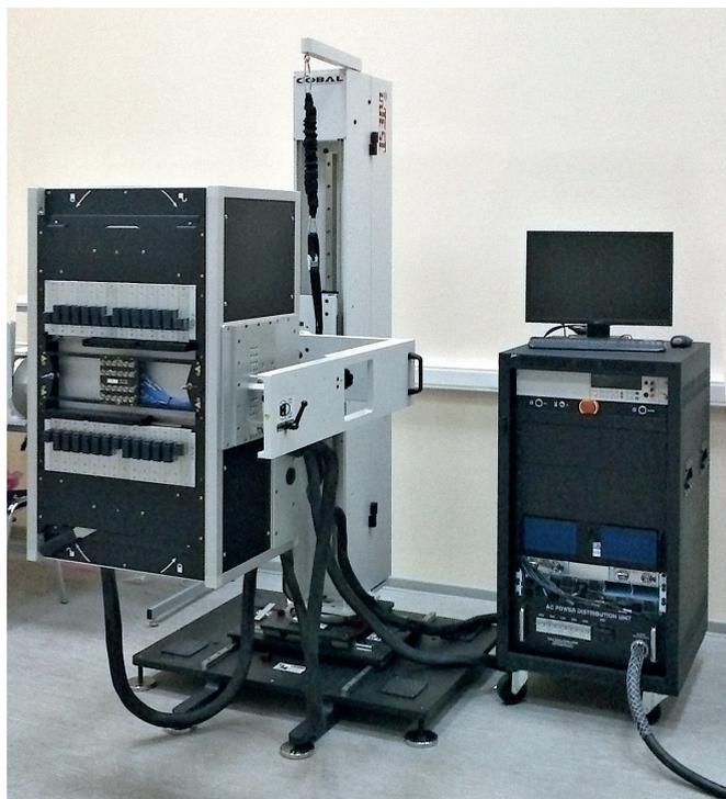
**Рис.2.** Система Test Evolution AX2820: измерительная стойка и манипулятор (слева); стойка электропитания со встроенным компьютером (справа)
