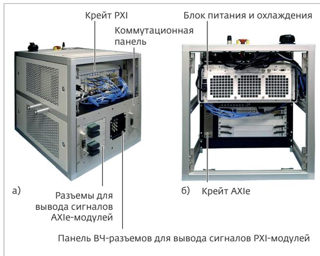
**Рис.3.** Размещение крейтов в системе AX518: а) вид спереди-сбоку; б) вид сзади
