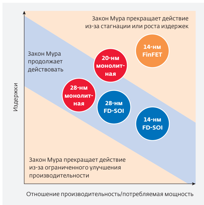
Рис.2. Продолжение действия закона Мура благодаря FD-SOI технологии
