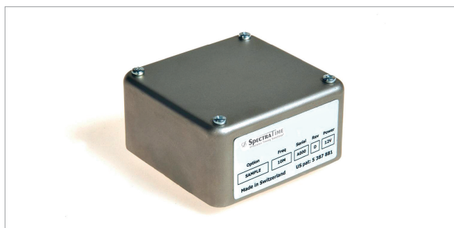
Рис.1. Недорогой рубидиевый генератор LCR-900
