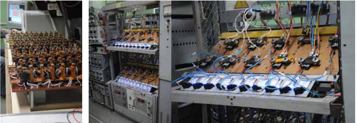
Модули питания на стенде системы автоматизированных измерений (слева), электротермотренировка модулей до заливки компаундом при 85°C (справа)
